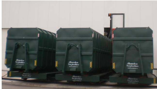
Слика 17.12.1-5. Помична колица за померање аброл контејнера
