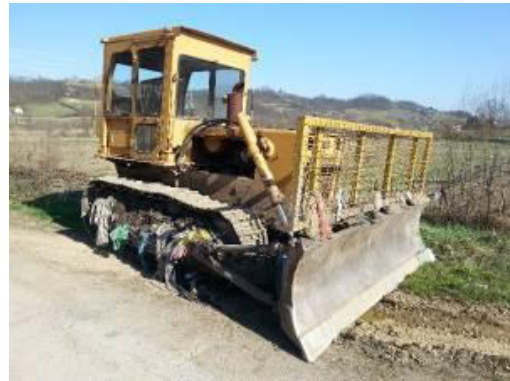
Слика 4.5.6-1. Булдозери за разастирање и равнање отпада на депонији ЈКП „Осечина“, "14 октобар"
