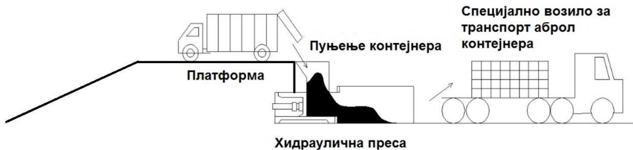
Слика 17.11.1-3. Принцип рада на трансфер станици – платформа за истовар
