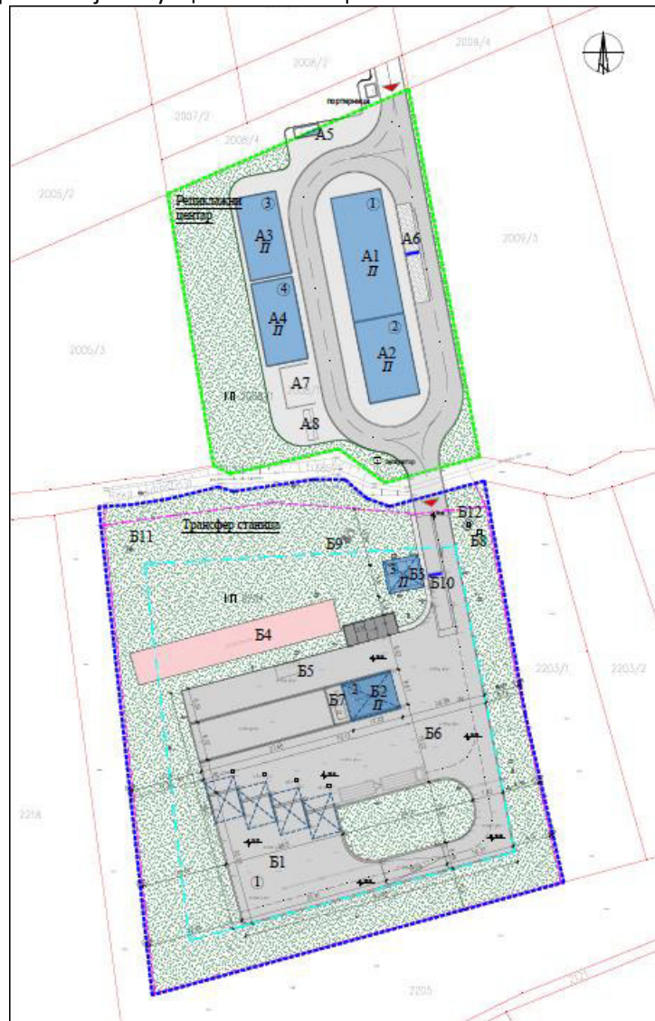
Слика 4.6.1.1-1. Ситуациони план Рециклажног центра и комплекса ТС Ваљево - постојеће стање
