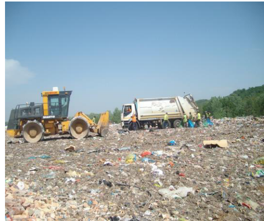
Слика 4.8.2-2. Компактор за рад на депонији и смећар
