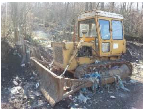
Слика 4.5.6-1. Булдозери за разастирање и равнање отпада на депонији ЈКП „Осечина“, "14 октобар"
