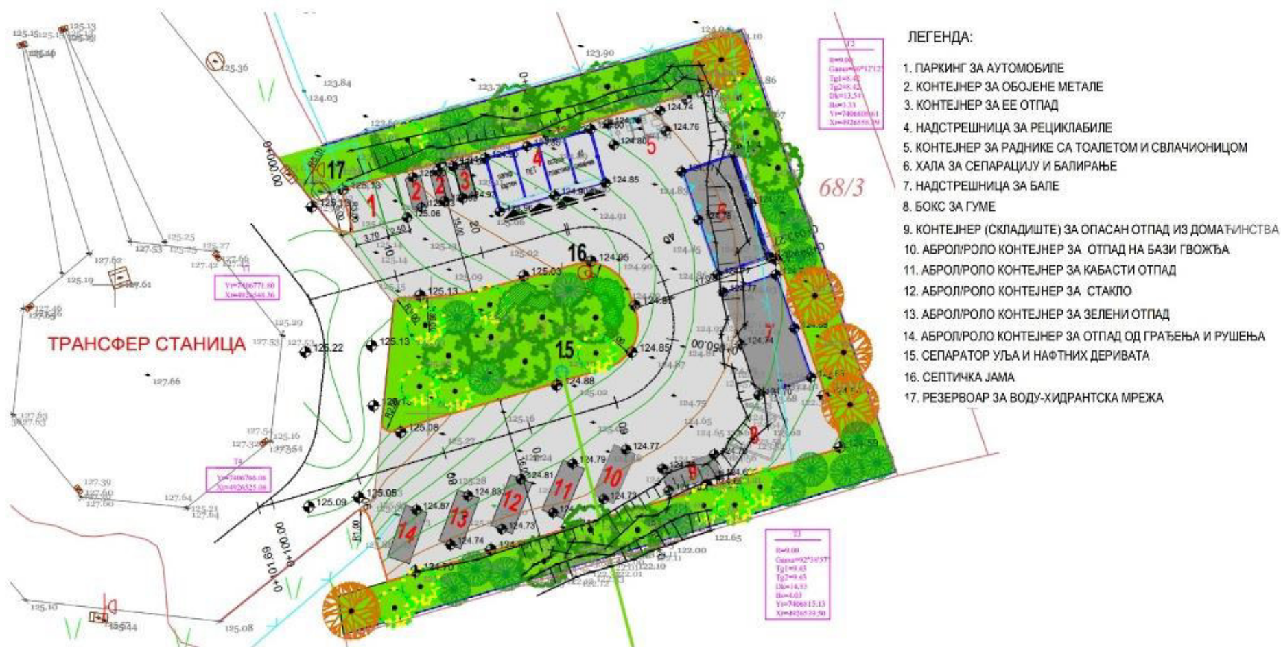
Слика 17.9-1. Ситуациони план рециклажног дворишта у Коцељеви (Извор ИДР, ЦИП 2023. године)
