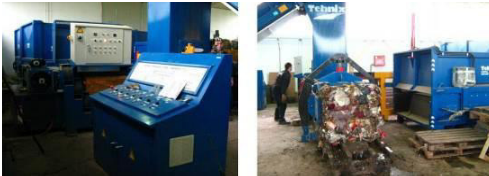
Слика 4.6.3-13. а) Командне табле за сортирницу и балирку; б) аутоматска преса - балирка
