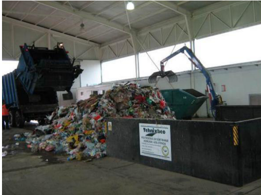
Слика 4.6.3-5. а) Истоваривање мешаног комуналног отпада у прихватну комору; б) прихватна комора са транспортером
