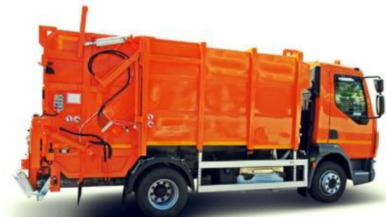
Слика 10-5. Типски камион смећар са потисном плочом
